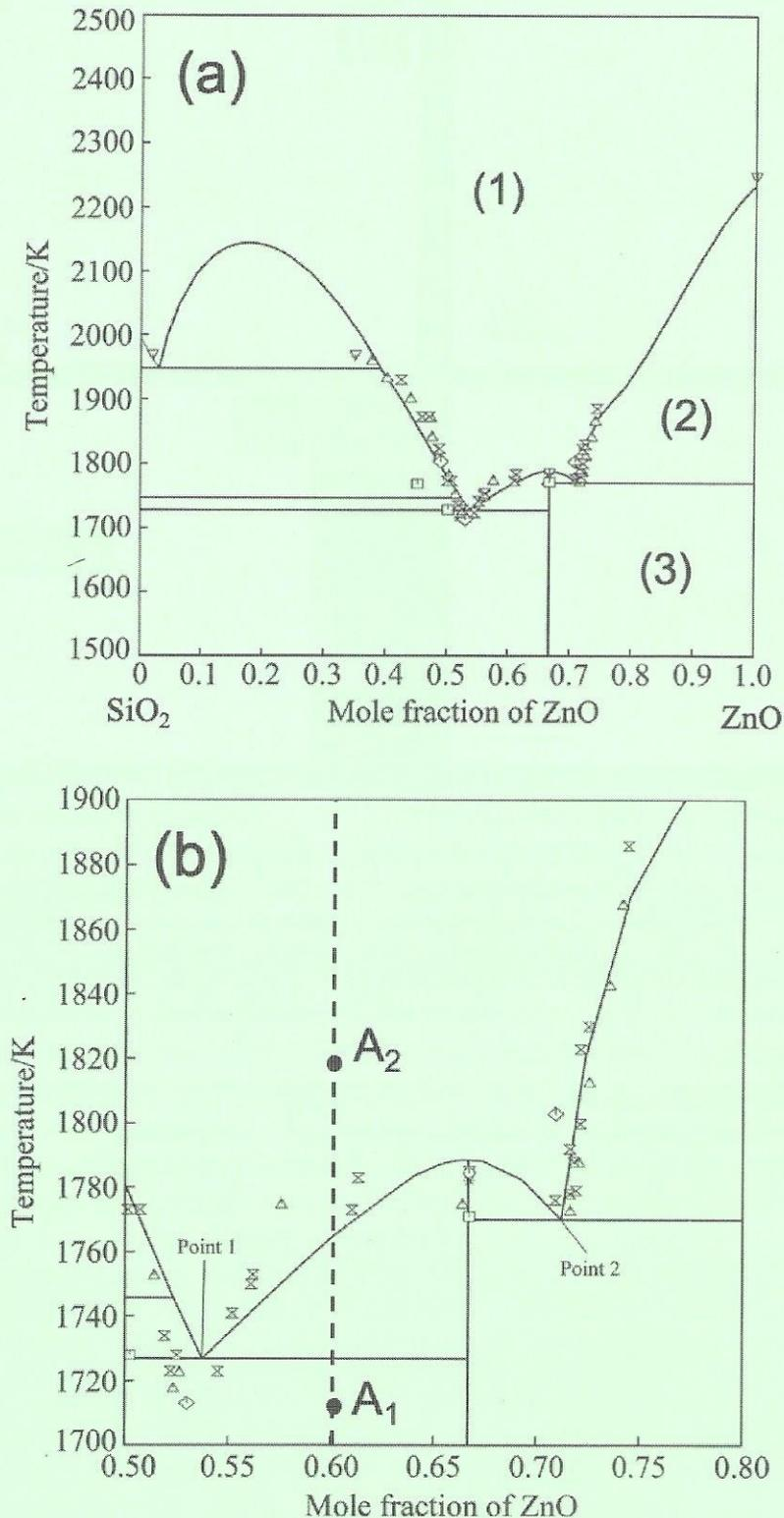
**Figure 9** : Diagramme de phase du système ZnO-SiO<sub>2</sub> à pression ordinaire.<sup>8</sup> (a) Diagramme complet, (b) agrandissement de la partie centrale du diagramme.
