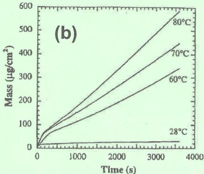
**Figure 5 :** (a) Densité de courant et (b) masse par unité de surface de ZnO déposé en fonction du temps lors de l'électrodépôt de ZnO à différentes températures. La concentration en  $O_2$  est fixée.<sup>5</sup>
