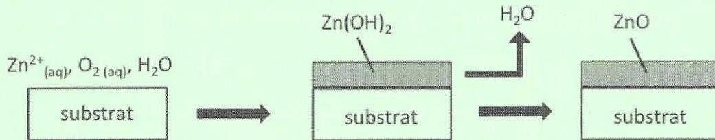
Schéma simplifié du procédé d'electrodepôt de ZnO
