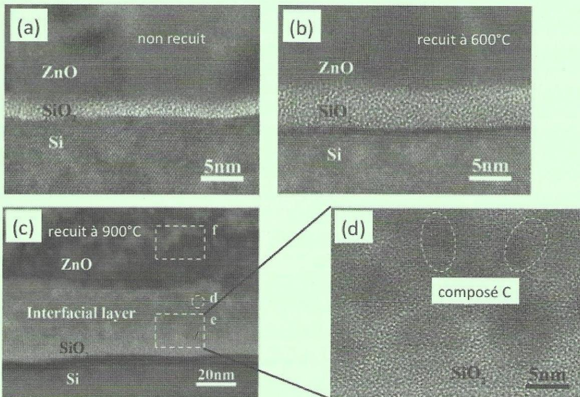
**Figure 8 :** Images en microscopie électronique à transmission (MET) d'une couche mince de ZnO déposée sur un substrat de silicium. (a) Sans recuit après le dépôt, (b) après un recuit à 600 °C après le dépôt, (c) après un recuit à 900°C, (d) vue agrandie d'une partie de la couche « *Interfacial layer* ».<sup>7</sup>
