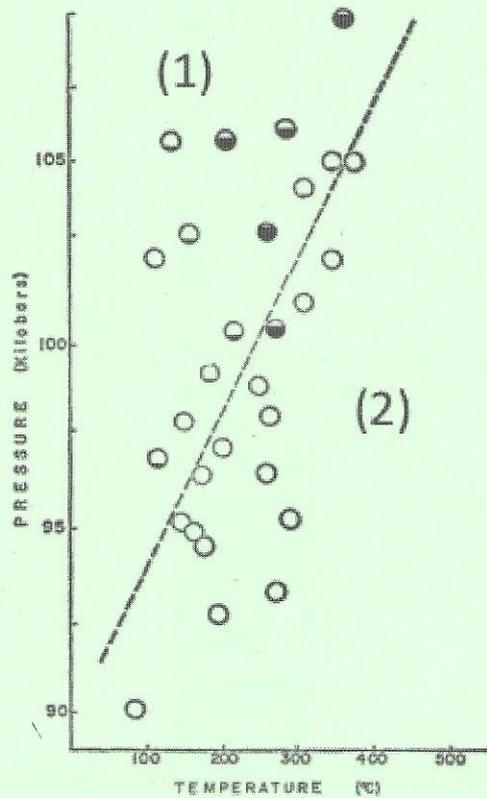
Figure 7 : Diagramme de phase pression-température de ZnO.<sup>6</sup>
