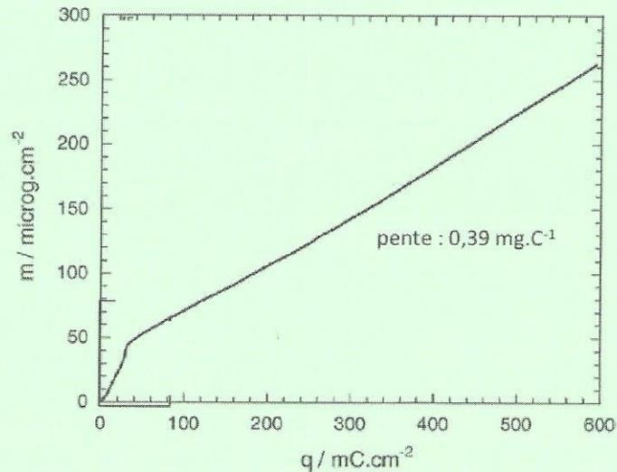
**Figure 4 :** Masse de ZnO déposée par unité de surface sur le substrat en fonction de la charge électrique par unité de surface échangée.<sup>4</sup>
