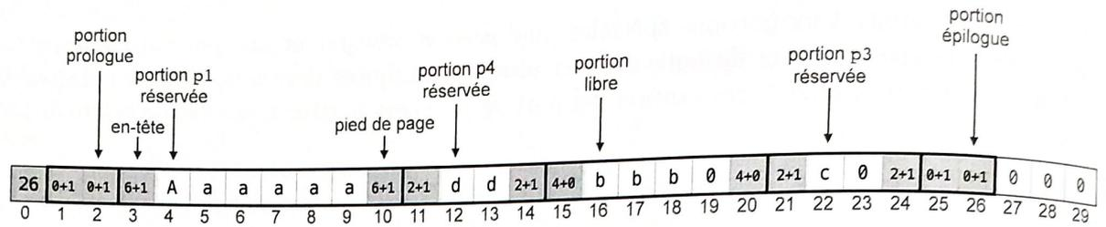
FIGURE 4 – Exemple de contenu de la mémoire après nouvelle réservation - Partie III.
