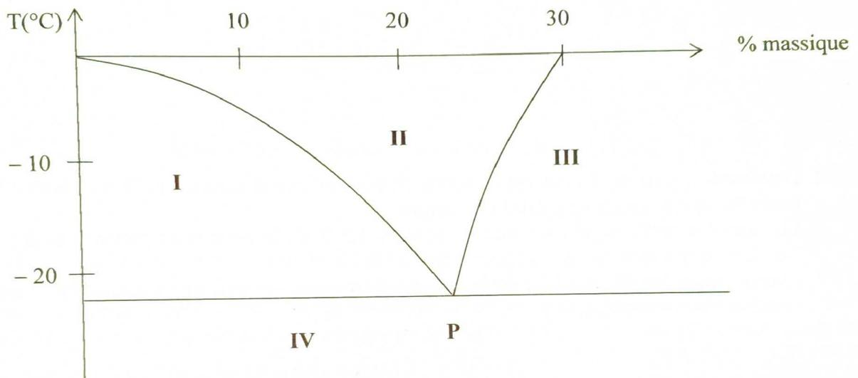
**Figure 9** - Diagramme binaire (eau-NaCl)
