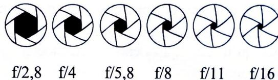
Lorsqu'on passe d'une valeur à l'autre (de la gauche vers la droite) on divise par 2 la surface d'ouverture du diaphragme. L'ouverture modifie également la profondeur de champ : une plus faible ouverture permet d'obtenir une plus grande profondeur de champ.
