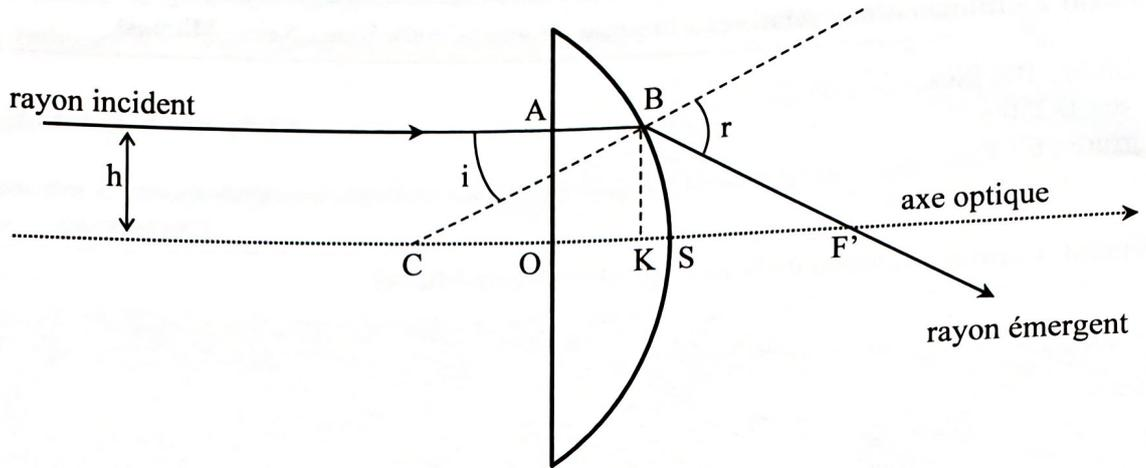
Figure 2 - Lentille plan-convexe
