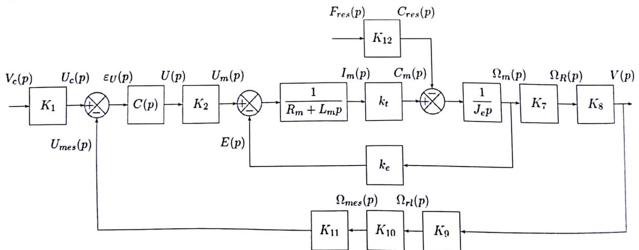
Figure 10 : Schéma-blocs de l'asservissement en vitesse du chariot
