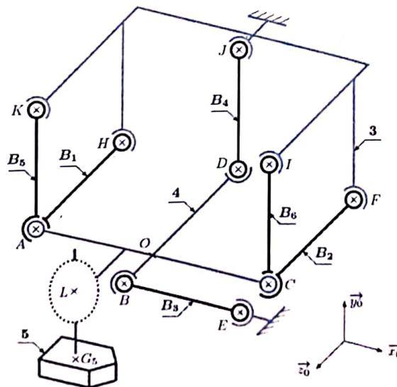
Figure 7 : Schéma cinématique 3D du dispositif de mesure
