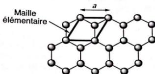
Figure 2. Structure du graphène.
