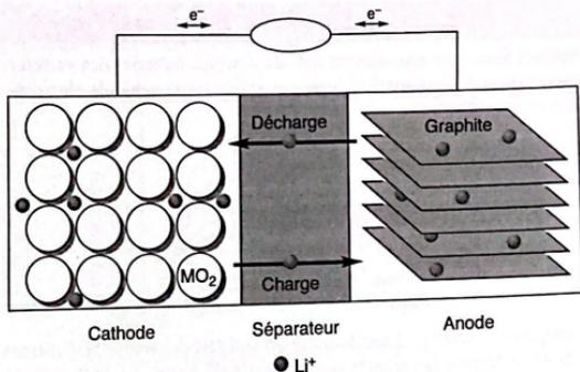
Figure 8. Représentation schématique d'une batterie Li-ion.
