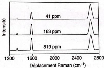
**Figure 4.** Évolution des spectres Raman du graphène en fonction de la concentration en méthane (en ppm).<sup>4</sup>
