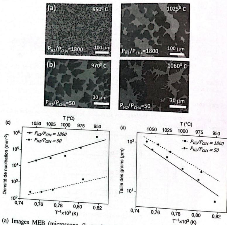
(a) Images MEB (microscope électronique à balayage) de croissances hexagonales à différentes températures pour  $\frac{P_{H_2}}{P_{CH_4}} = 1800$ . (b) Images MEB de croissances dendritiques à différentes températures pour  $\frac{P_{H_2}}{P_{CH_4}} = 50$ . Diagrammes d'Arrhénius pour (c) la densité de nucléation et (d) la taille des grains.
