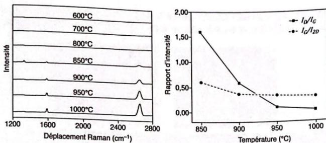
**Figure 3.** Spectres Raman de croissance CVD en fonction de la température (gauche) et variation du rapport des intensités  $I_D/I_G$  et  $I_G/I_{2D}$  en fonction de la température (droite).<sup>3</sup>
