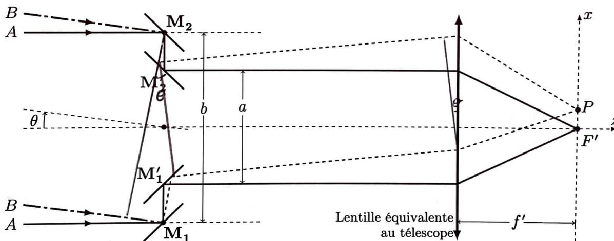
FIGURE 4 – Le schéma équivalent au dispositif interférentiel.
