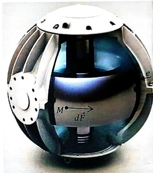
Pour simplifier le problème, la surface extérieure du volant d'inertie peut être modélisée par un cylindre de révolution de hauteur  $H = 40 \text{ cm}$  et de diamètre  $D = 1 \text{ m}$ .
