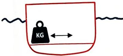
Dans ces systèmes, des masses sont installées au fond de la cale. Elles sont guidées et motorisées transversalement au bateau pour pouvoir être placées à gauche ou à droite et créer ainsi un couple s'opposant à la houle qui génèrerait du roulis. C'est, par exemple, une solution installée sur le porte-avion Charles de Gaulle.
