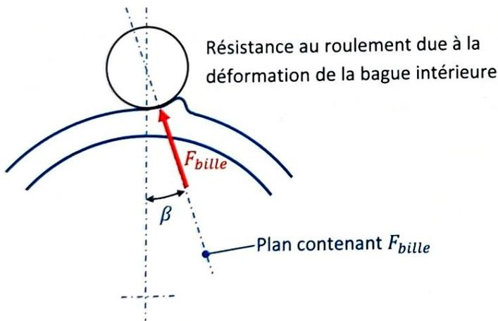
Par ailleurs, la déformation de la bague intérieure génère un « bourrelet », très largement augmenté sur la figure ci-contre devant chaque bille. Ce phénomène, appelé résistance au roulement, génère un couple  $C_{r\ billes}$  qui s'oppose à la rotation de la bague intérieure.
