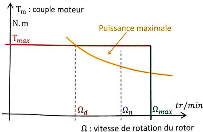
Zone à couple limité à  $T_{max} = 12 \text{ N} \cdot \text{m}$  jusqu'à  $\Omega_d = 3000 \text{ tr/min}$
