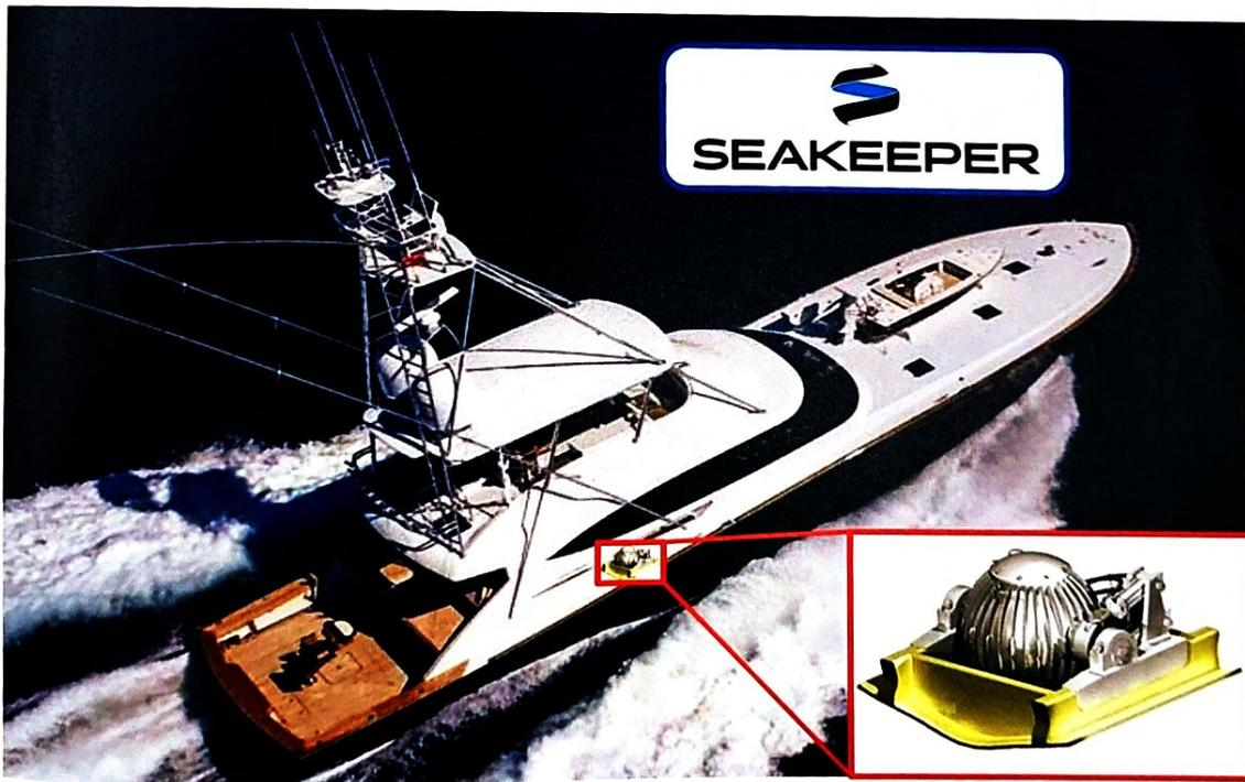
« Satu 90 » équipé d'un gyrostabilisateur Seakeeper
