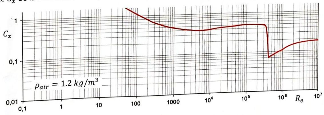
**Question 27 :** déterminer littéralement la puissance perdue par une bille dans l'air. En déduire la perte énergétique théorique dans les deux roulements à billes due aux forces de trainée sur les billes. Faire l'application numérique et conclure.
