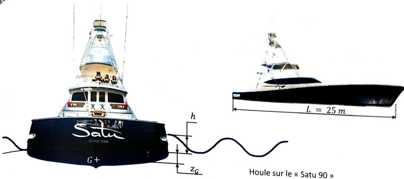
La situation étudiée est une situation d'une houle créant une différence de hauteur  $h = 0.5 \text{ m}$  entre le côté tribord (droit) et le côté babord (gauche) du navire. Dans ces conditions la houle exerce des actions  $F_{mer}$  qui génèrent une rotation du navire autour d'un point  $G$ , que l'on considèrera être un point situé à  $z_G = 0.5 \text{ m}$  sous la surface de la mer.
