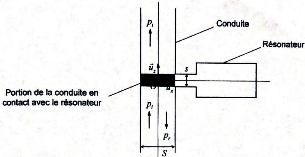
Figure 10 - Résonateur de Helmholtz connecté à une conduite
