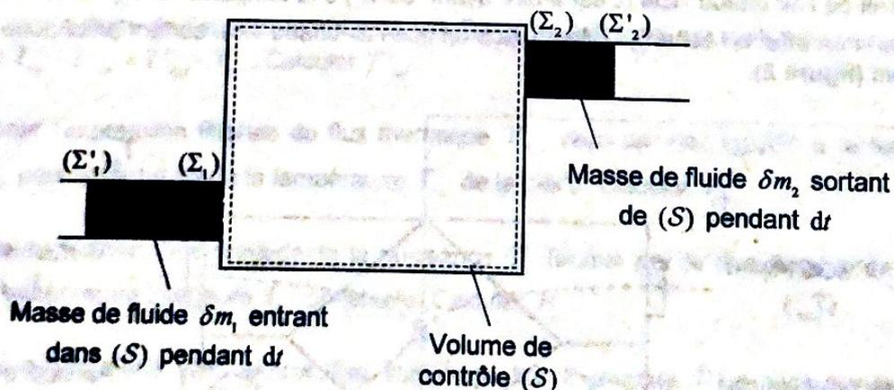
Figure 1 - Fluide en écoulement stationnaire : système fermé étudié
