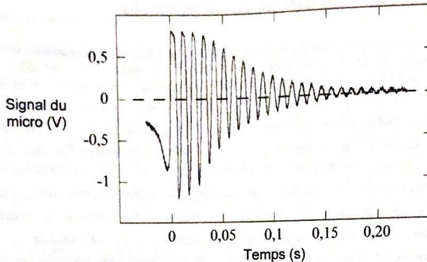
**Figure 9** - Oscillations libres d'un résonateur de Helmholtz
