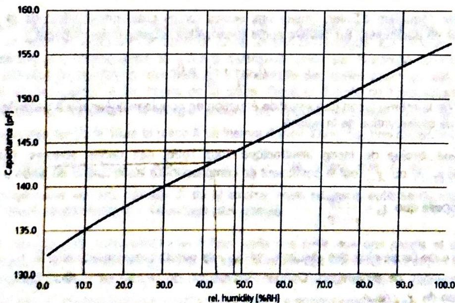
Figure 6 - Courbe d'étalonnage du capteur
