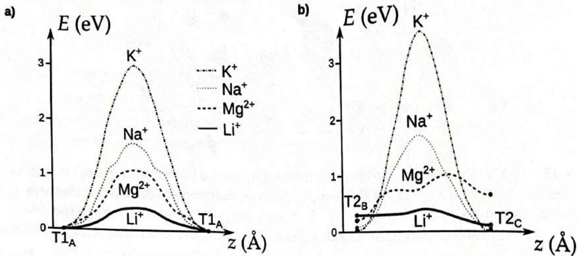
FIGURE 21 – Profils énergétiques pour la progression des cations dans les différents canaux. Les indices A, B, C font référence aux minimums énergétiques décrits dans le texte. Les énergies sont exprimées en électron-volt et les coordonnées de réactions en abscisse correspondent à la progression du cation selon l'axe Oz de la maille. La référence en énergie correspond au site T1<sub>A</sub>.
