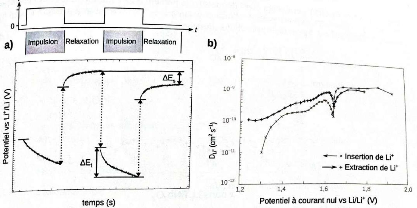
FIGURE 22 – a) Allure typique d'une expérience de GITT pour une mesure lors de deux cycles au cours d'une expérience d'insertion. b) Résultat de la mesure pour une électrode en  $\text{TiNb}_2\text{O}_7$ . Les flèches indiquent le sens d'évolution du potentiel lors de la charge (insertion) et de la décharge (extraction).
