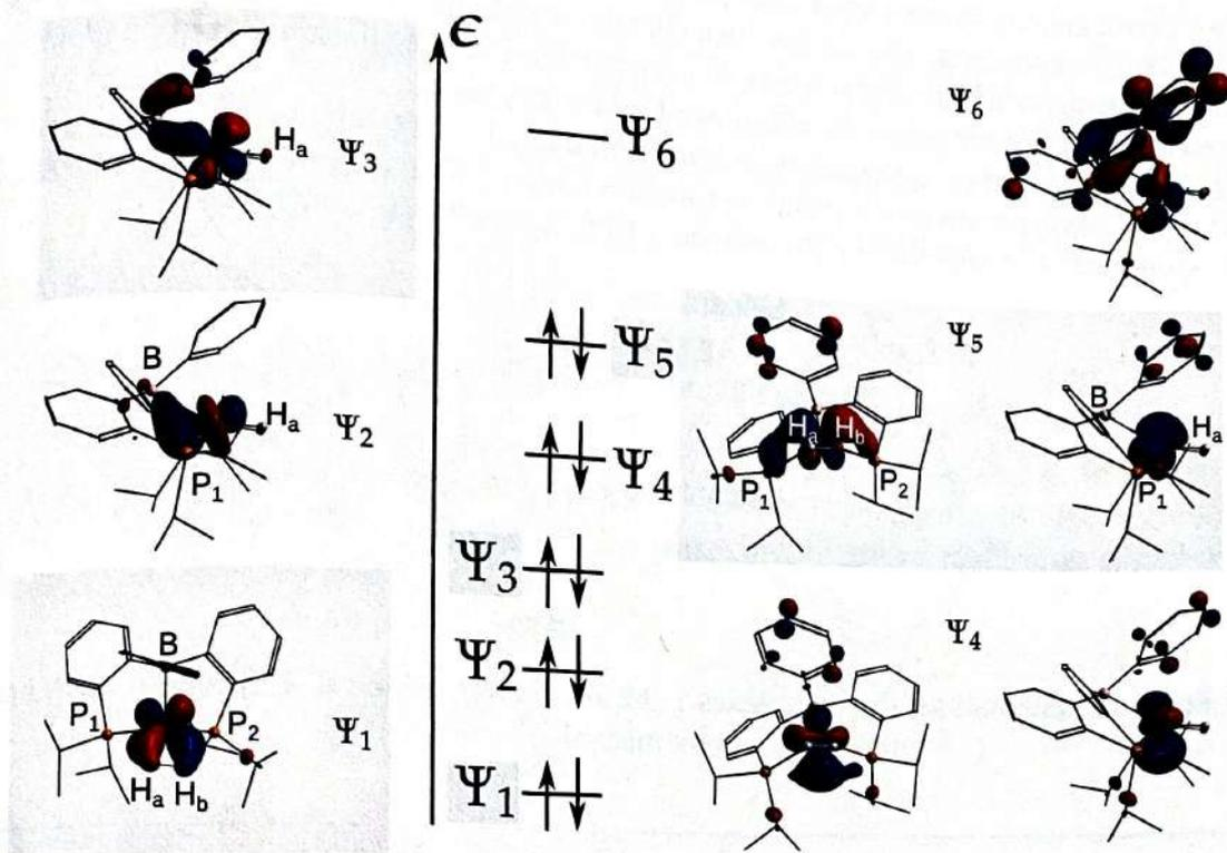
FIGURE 7 – Orbitales de valence pour le complexe 1 (de la HO-4 à la BV). Tous les atomes d'hydrogène autres que ceux directement liés à l'atome de nickel sont omis pour plus de clarté.
