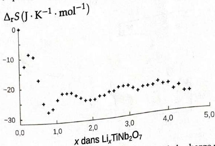
FIGURE 23 –  $\Delta_r S$  en fonction du nombre d'ions lithium insérés, lors de la charge pour une électrode en  $\text{TiNb}_2\text{O}_7$ .
