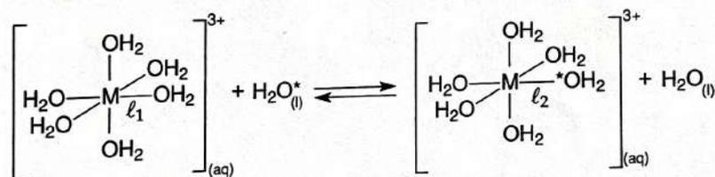
FIGURE 1 – Représentation de la liaison  $\ell_1$  rompue et de la liaison  $\ell_2$  formée lors de la réaction d'échange de ligand autour de l'ion central  $\text{M} = (\text{Al}; \text{Ga}; \text{In})$ . L'exposant \* sert uniquement à distinguer la molécule d'eau échangée lors de la réaction.
