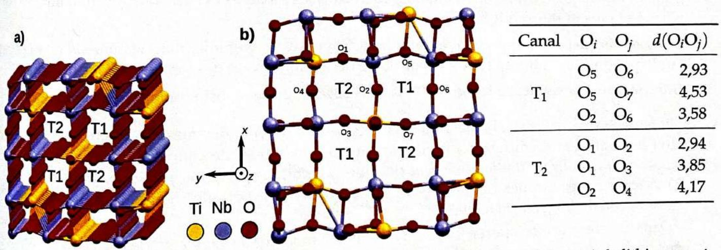
FIGURE 20 – a) Représentation tridimensionnelle des canaux de TiNb<sub>2</sub>O<sub>7</sub> dans lesquels le lithium peut s’insérer. b) Représentation des canaux selon l’axe Oz avec certains atomes d’oxygène indiqués. Tous ces atomes sont dans le même plan et les distances interatomiques sont données dans le tableau. Ce dernier donne quelques distances entre atomes d’oxygène représentés en b), exprimées en Å.
