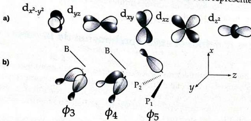
FIGURE 6 – a) Surface d'isodensité pour les orbitales d de l'atome de nickel. b) Représentation des trois orbitales du fragment «  $BP_1P_2$  » prises en compte pour étudier le complexe modèle. La représentation est une vue « de profil » comme sur la figure 5 b).
