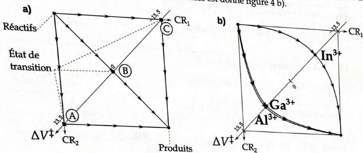
FIGURE 4 – a) Diagramme de More-O'Ferrall pour les trois mécanismes limite présentés tableau 1. b) Diagramme pour les trois ions  $Al^{3+}$ ,  $Ga^{3+}$  et  $In^{3+}$ . Le volume d'activation est donné sur la diagonale en  $mL \cdot mol^{-1}$ ; les nombres 13,5; 0; -13,5 correspondent à la valeur de  $\Delta V^\ddagger$  aux points A, B et C respectivement.
