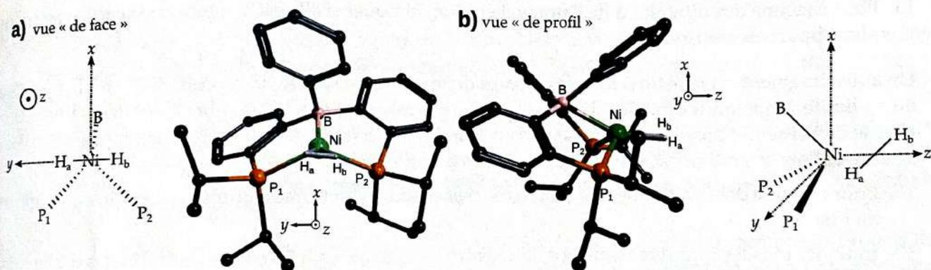
FIGURE 5 – Deux vues du complexe de nickel étudié, noté **1** : a) de face, b) de profil. Pour la représentation tridimensionnelle, tous les atomes d'hydrogène autres que ceux directement liés à l'atome de nickel sont omis pour plus de clarté. Pour le complexe modèle, seule la première sphère de coordination est représentée.
