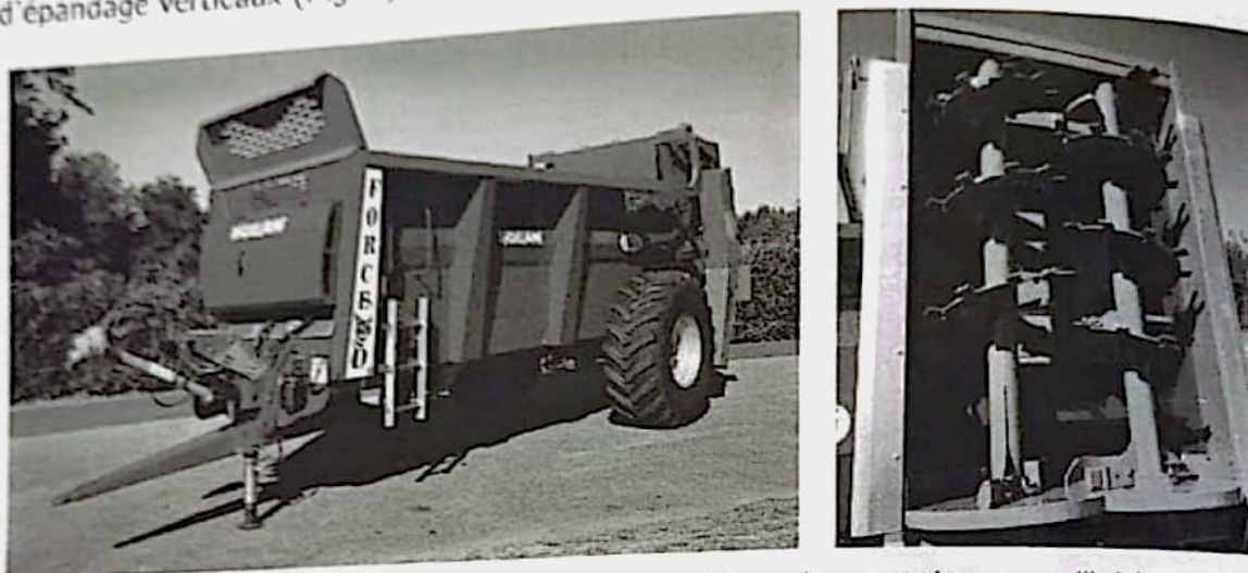
Figure 4 – Gamme "FORCE" munie de rotors d'épandage verticaux ou "hérissons".
