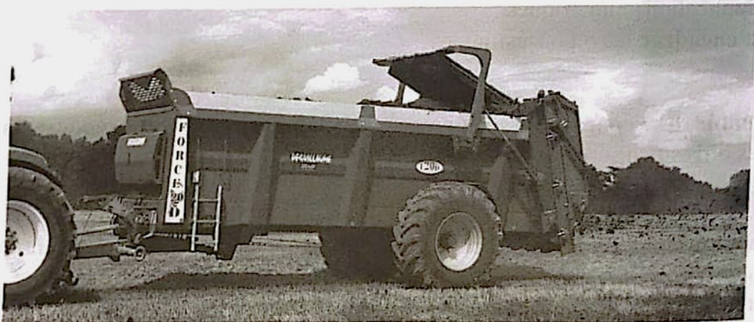
Figure 2 – Exemple d'épandeur à caisse étroite "FORCE 20 D" de volume utile 20 m 3 .
