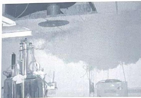
FIGURE 2 – Fuite d'hélium suite à la destruction (*quench*) d'un aimant supraconducteur utilisé pour la RMN. Département de Chimie de l'université de l'Alberta
