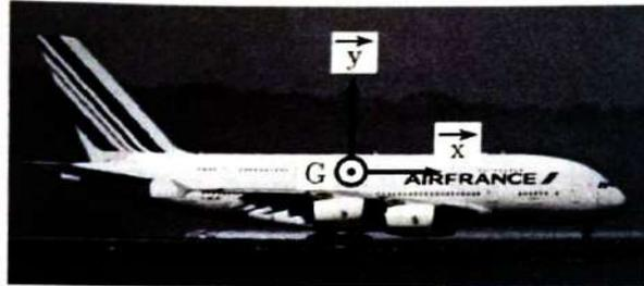
FIGURE 4 – Schéma d'étude - A380 en phase de freinage.
