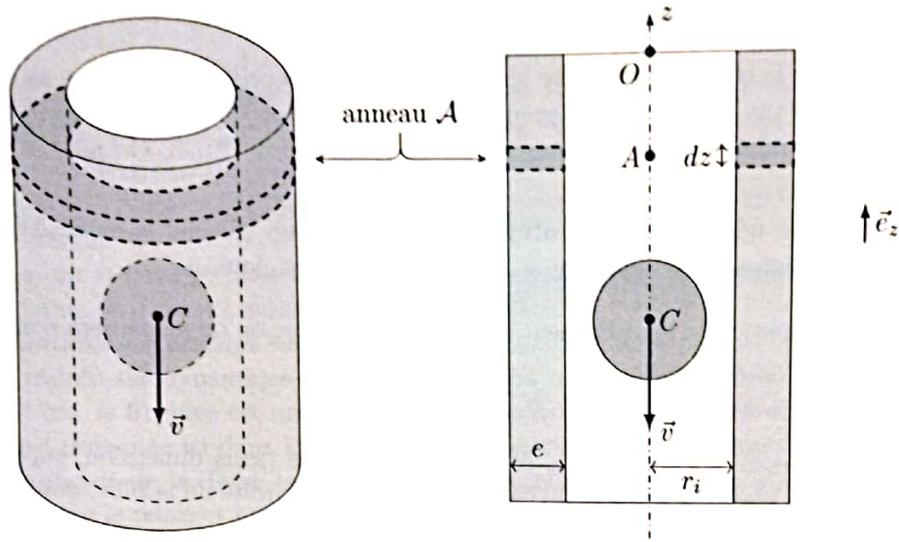
FIGURE 2 – Représentation perspective et en coupe de la chute de l'aimant (échelles non respectées)
