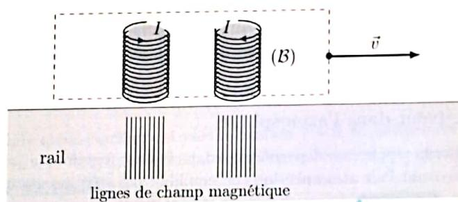
FIGURE 4 – Système de freinage ferroviaire à courants de Foucault
