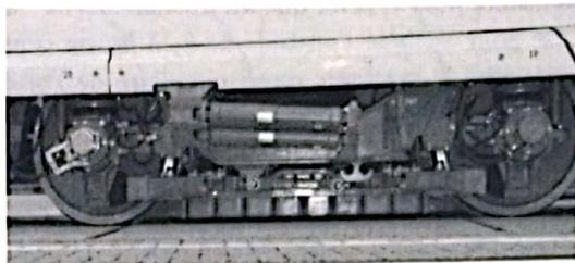
FIGURE 3 – Bobines d'un frein électromagnétique KNORR sur train de type VELARO
