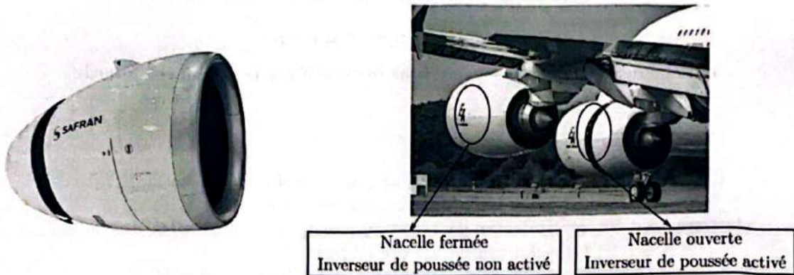
FIGURE 1 - Nacelle complète du groupe SAFRAN et mise en évidence d'un inverseur de poussée activé sur une nacelle lors d'un atterrissage.
