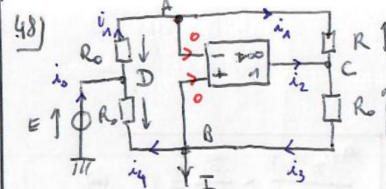
$$\text{LDN en A en potentiel : } \frac{V_D - V_A}{R_o} = 0 + \frac{V_B - V_C}{R}$$
