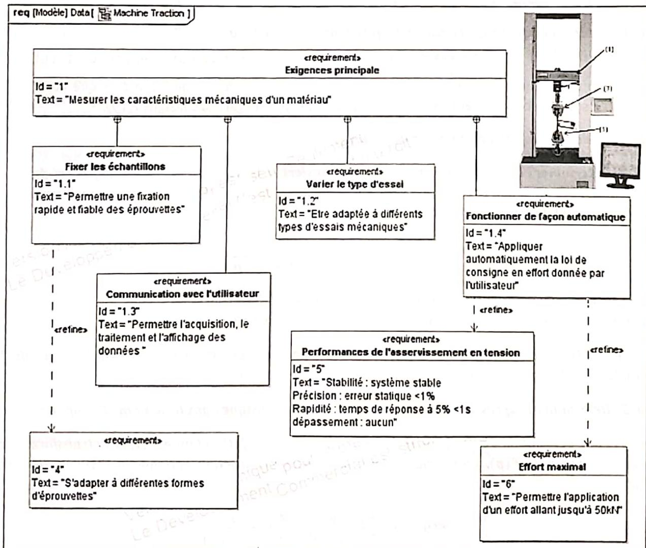
Figure 1 : Diagramme des exigences partiel de la machine d'essai universelle
