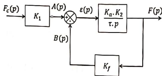
Figure 2 : modèle de comportement de la machine d'essais
