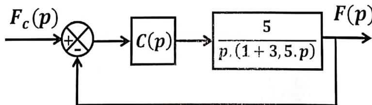
Un correcteur proportionnel  $C(p) = K_{cor}$  a été placé juste après le comparateur du boîtier électronique ( $C(p) = 1$  dans la partie précédente).
