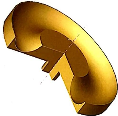
Figure 2 : détail d'une surface torique liée au solide (1) ou (2).
