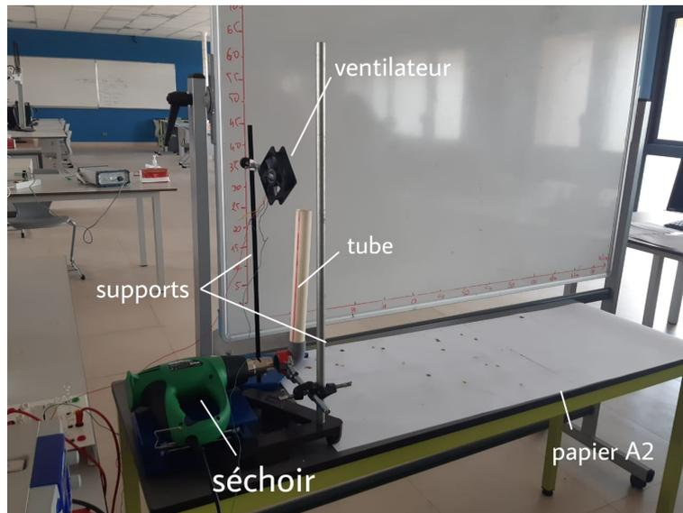
Figure 16: Montage expérimental
