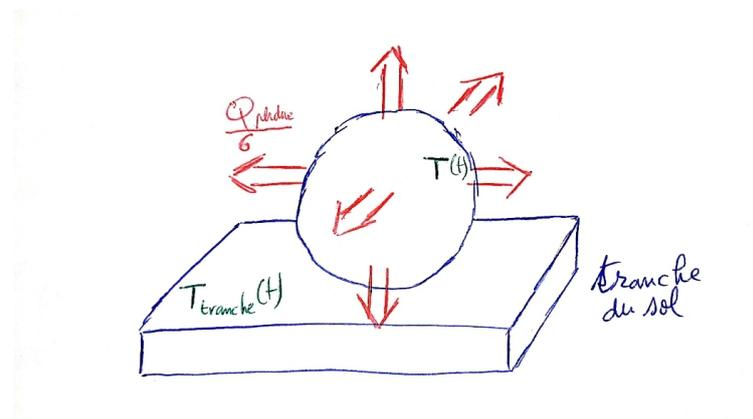
Figure 12: Bilan thermique sur le brandon atterrit et la tranche du sol
