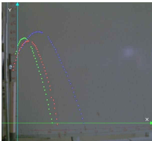
Figure 17: Trajectoires des brandons prises à l'aide d'une caméra rapide
