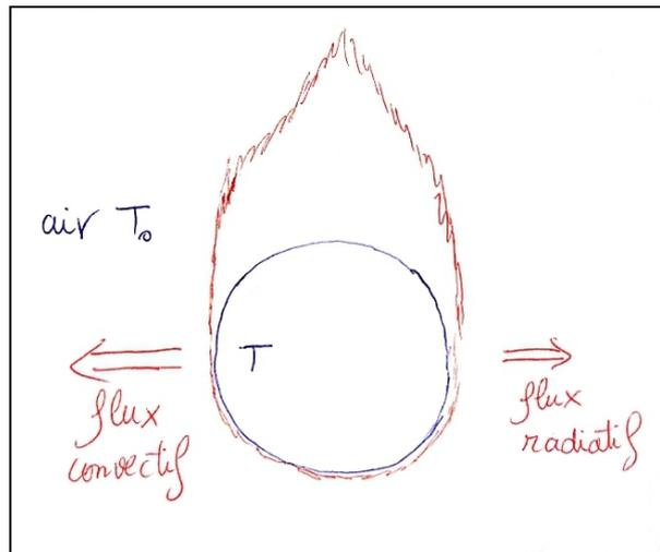
Figure 10: Bilan thermique sur le brandon
