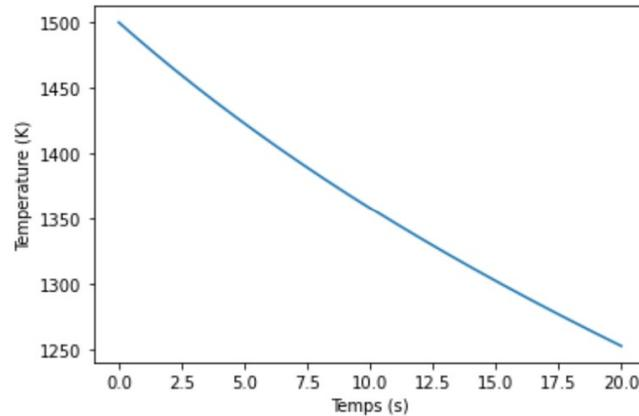
Figure 11: Évolution de la température de la particule lancée,  $\epsilon = 0.9$ ,  $h = 5W/(m^2K)$ ,  $T_0 = 300K$ ,  $T_{initiale} = 1500K$ ,  $C_p = 500J/(kgK)$
