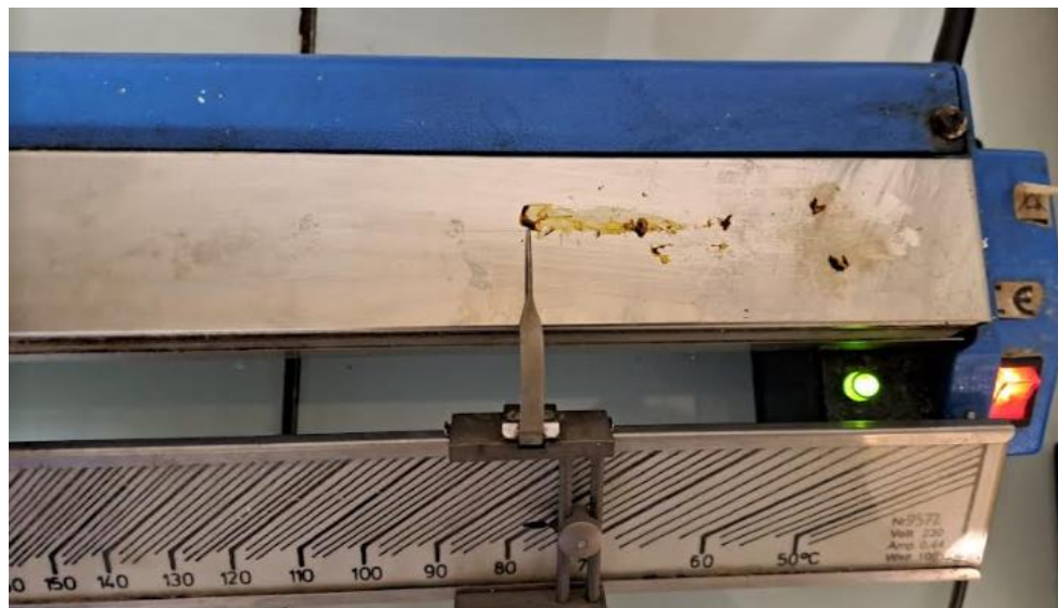
Mesure du point de fusion
