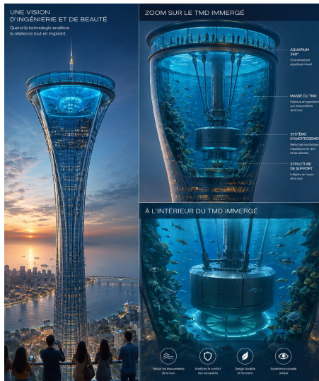
Figure – Conception d'une tour avec un TMD immérgé
