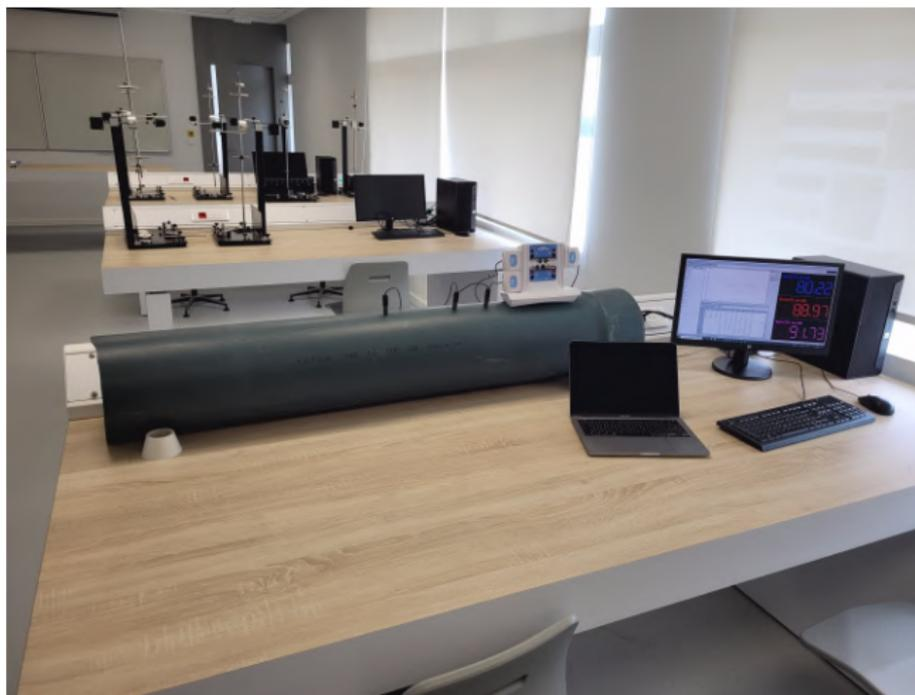
Figure 15: Montage N°2: Tube à impédance (25cm)
