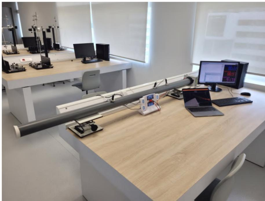
Figure 14: Montage N°1: Tube à impédance (7cm)
