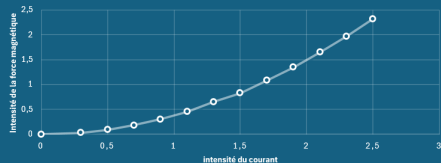
VARIATIONS DE LA FORCE MAGNETIQUE EN FONCTION DU COURANT ÉLECTRIQUE À ENTREFER CONSTANT (1CM)
