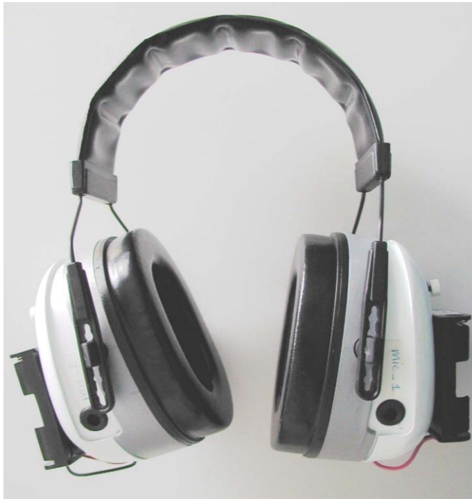
Prototype de casque développé par l'IRSST, Québec
