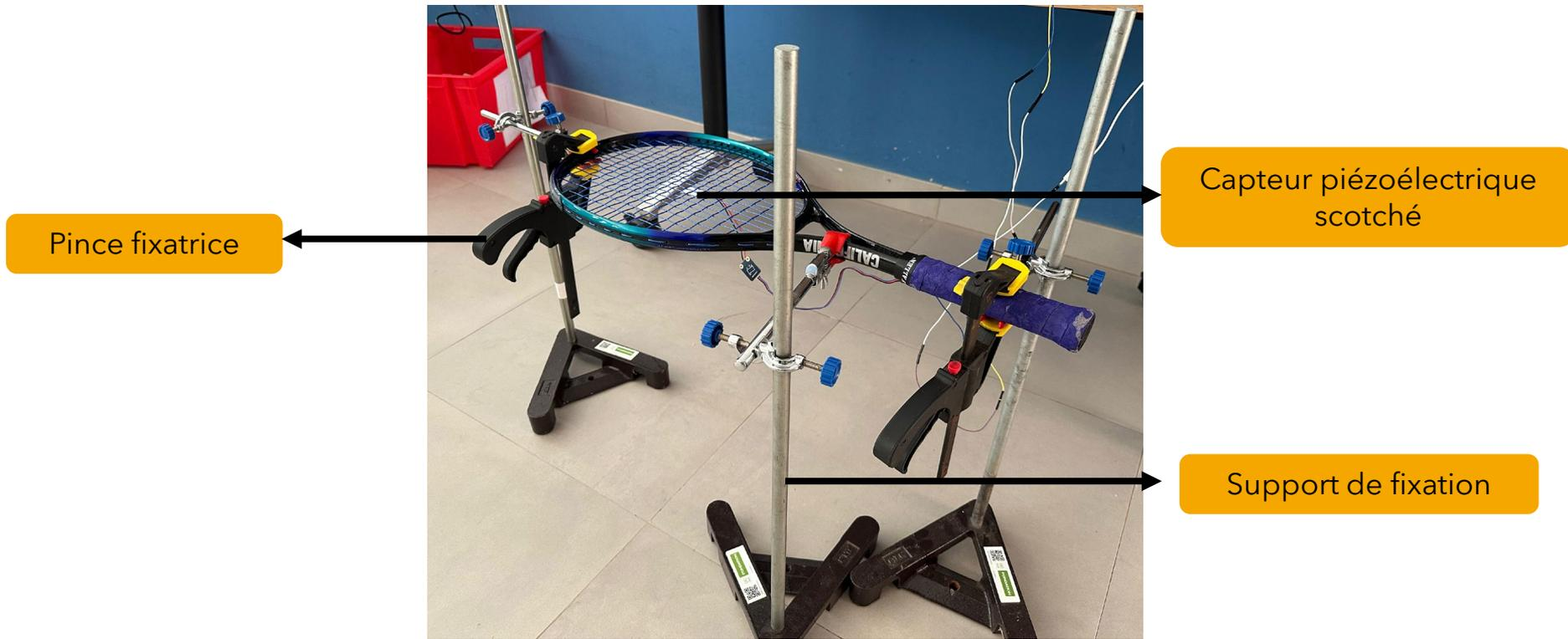
Figure-18 : fixation de la raquette
