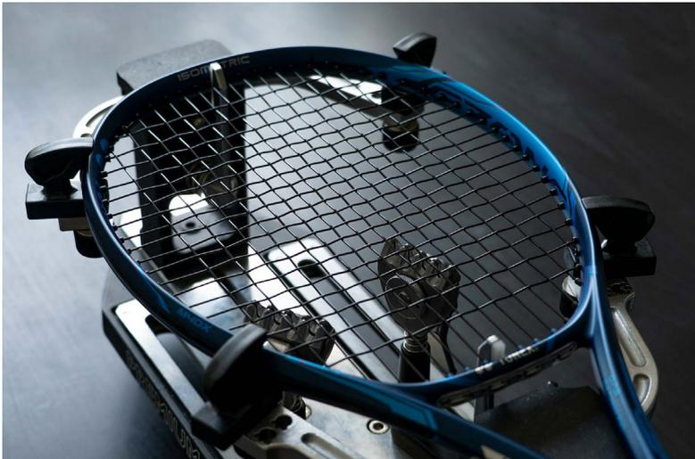
Figure-1 : raquette sur une machine à cordage
