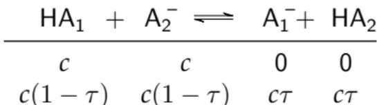
$\tau/(1 - \tau) = 10^{\frac{1}{2}(\text{p}K_{\text{a}_2} - \text{p}K_{\text{a}_1})}$  donc  $\tau$  élevé  $\Leftrightarrow \text{p}K_{\text{a}_2} - \text{p}K_{\text{a}_1}$  élevé.
