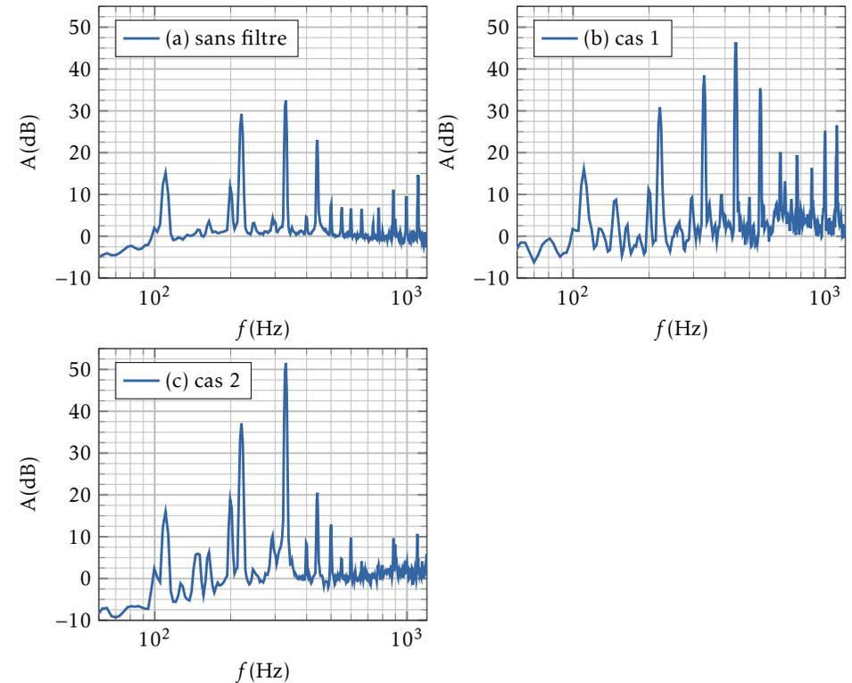
FIGURE 6 – Spectres obtenus par transformation de Fourier rapide. Pour un signal d'amplitude  $U$ , l'amplitude  $A$  en dB est  $A = 20 \log(U/U_{ref})$ , avec  $U_{ref}$  une tension de référence.
