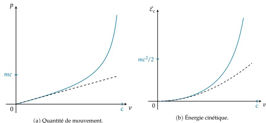
Fig. 8 : Quantité de mouvement  $p$  et énergie cinétique  $\mathcal{E}_c$ . Les courbes en traits pleins sont celles de la dynamique relativiste. Celles en traits interrompus l'approximation de la mécanique classique.
