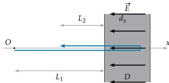
FIG. 2 : Trajet d'un faisceau électronique dans un réflecteur. On a décalé l'aller et le retour pour plus de lisibilité bien qu'ils soient superposés.
