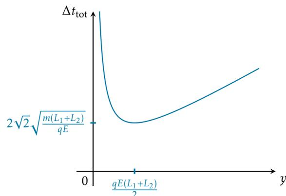
FIG. 6 : Variation du temps de vol avec l'énergie cinétique initiale.
