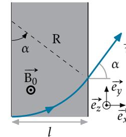
FIG. 7 : Trajectoire d'un électron dans une zone de champ magnétique uniforme.
