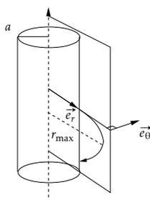
3. La norme de la vitesse est conservée puisque le champ magnétique ne travaille pas et qu'il n'y a pas de champ électrique. On a donc  $\sqrt{\dot{r}^2 + \dot{z}^2} = v_0 = \dot{r}_0 > 0$ . La norme de la vitesse axiale  $\dot{z}$  sera donc maximale en  $r_0$  pour  $\dot{z} = -v_0$  quand le rayon sera maximal en  $r_{\text{max}} = ae \left(\frac{2\pi m v_0}{e\mu_0 I}\right)$ .
