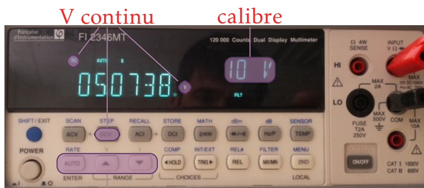
(a) Le multimètre mesure ici 5,0738 V en continu (DC), sur un calibre de 10 V, réglé automatiquement AUTO.
