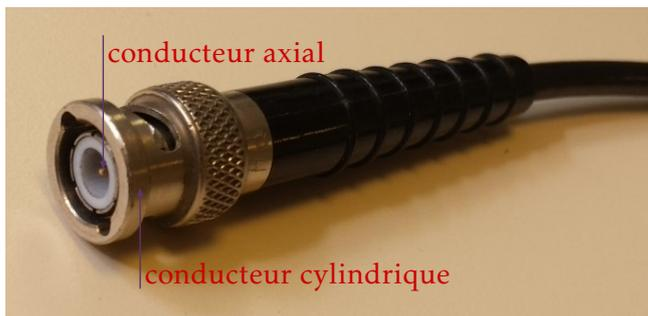
(a) Câble coaxial. Un seul câble contient deux conducteurs métalliques.
