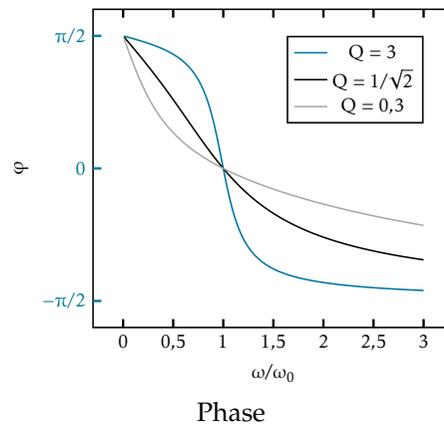
Intégration numérique du mouvement d'un oscillateur harmonique amorti en régime sinusoïdal forcé
