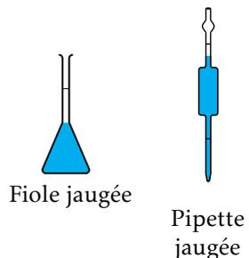
Ces instruments permettent de mesurer très précisément leur volume nominal (par exemple 100 mL pour une fiole et 20 mL pour une pipette). Ce volume est mesuré jusqu'au trait dit *de jauge* pour la fiole et entre les deux traits de jauge pour la pipette : on ne doit jamais vider complètement la pipette jaugée pour verser le volume nominal. La fiole est utilisée pour réaliser des dilutions, la pipette pour prélever un volume donné d'une solution.
